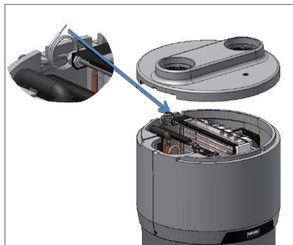
Fig.12 - Cavi per connessione remota
