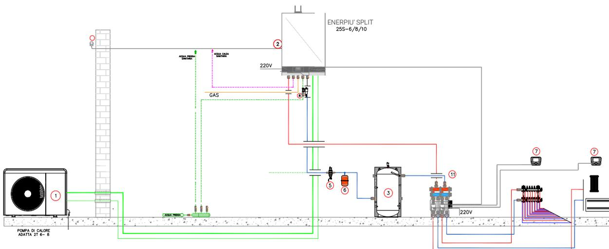
N.B.: verificare la necessità di installazione di un accumulo inerziale sul ritorno dell'impianto al fine di garantire il corretto funzionamento della PDC
