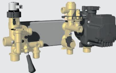
Gruppo idraulico compatto in ottone. Gruppo di mandata con deviatrice motorizzata, by-pass e rubinetto di carico impianto integrati. Circolatore ERP con sblocco pompa manuale su gruppo di ritorno.
