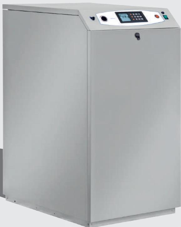
Generatore di calore ad acqua calda a condensazione e a basse emissioni inquinanti di tipo B23, B33, C43, C53, C63, C83, costituito da uno scambiatore in alluminio ad alte prestazioni, bruciatore ad aria soffiata premiscelato a basse emissioni inquinanti con funzionamento modulante. Completa di termoregolazione climatica realizzabile mediante abbinamento con sonda esterna per la gestione variabile della temperatura acqua in mandata all'impianto.
